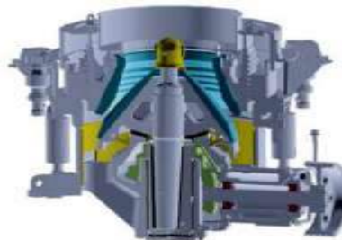
CONCASOARE CU CON SECUNDARE SI TERTIARE CC
